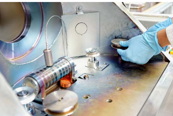
Garnbeschichtungsanlage für leitfähige Garne
